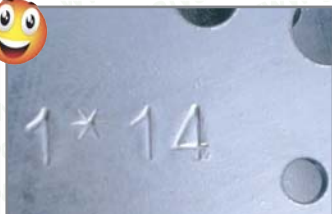
Photos 56 et 57 : La frappe à froid
