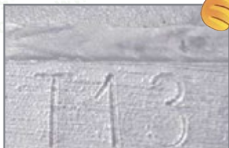
Photos 56 et 57 : La frappe à froid
