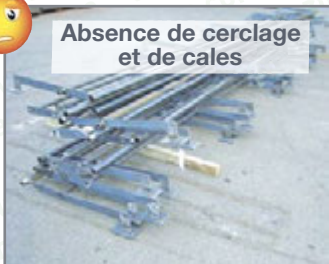
Photos 62 et 63 : Mauvais colisages
