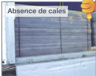
Photos 62 et 63 : Mauvais colisages
