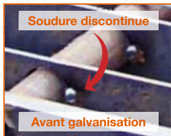
Photos 48 et 49 : Les défauts de soudures discontinues
