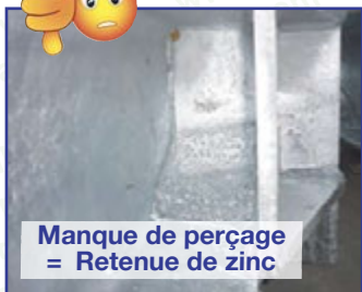
Photos 29 et 30 : Grugeages et perçages
