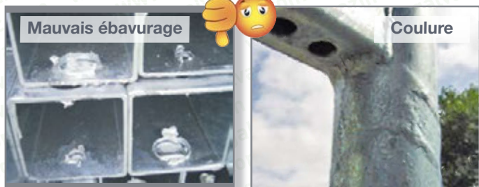
Photos 60 et 61 : Défauts d'ébavurage et de coulure
